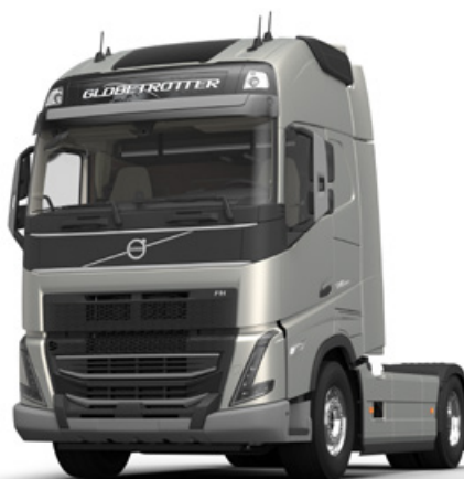
ALAPDIZÁJN ROBUSZTUS HOMLOKRÉSSZEL. Nagy igénybevételre tervezett lökhárító. Fekete hűtőrács és szürke lökhárító, tükrök és egyéb részletek. Csak a fülke kap fényezést.
